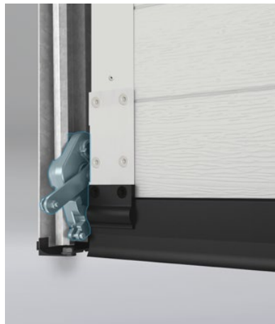
Sicherheitsbremse, die das Herabfallen des Torflügels bei Seilbruch verhindert
